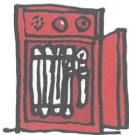
屋内消火栓設備
