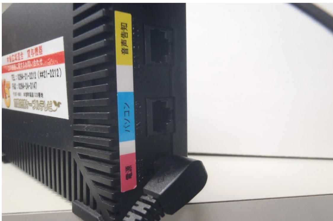
LANケーブルを差し込み、機器（PC・無線ルーター）と接続し電源を入れてください。
