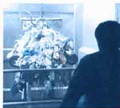
ゴミピット内のゴミ攪拌操作
